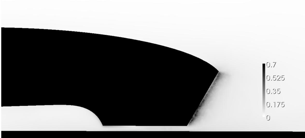
FIG. E.10 – Énergie cinétique de turbulence autour de l'Alérion, au milieu.
