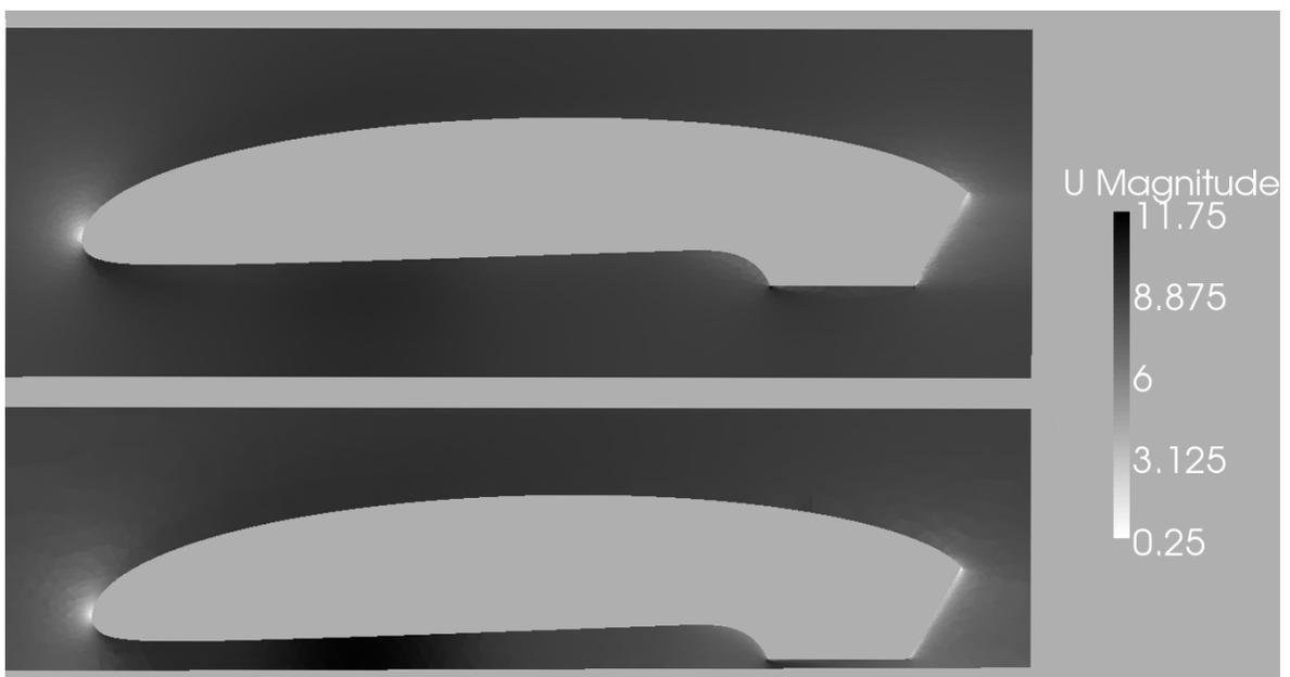
FIG. E.14 – Comparaison des vitesses sous l'Alérion.
